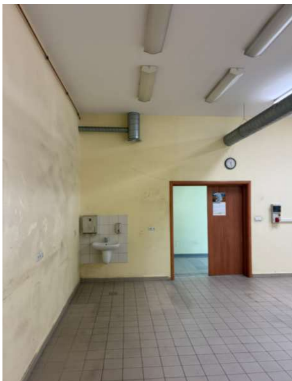
Sciana z drzwiami wejściowymi do pomieszczenia 23. Widioczne kanały wentylacji mechanicznej, umywalka, rozdzielnia elektryczna i gniazda (220 v i siła) Na zdjęciu po prawej stronie widoczne miejsce gdzie stanie komora próżniowa. Na zdjęciu po lewej stronie widoczne miejsca gdzie stanie system wibracyjny
