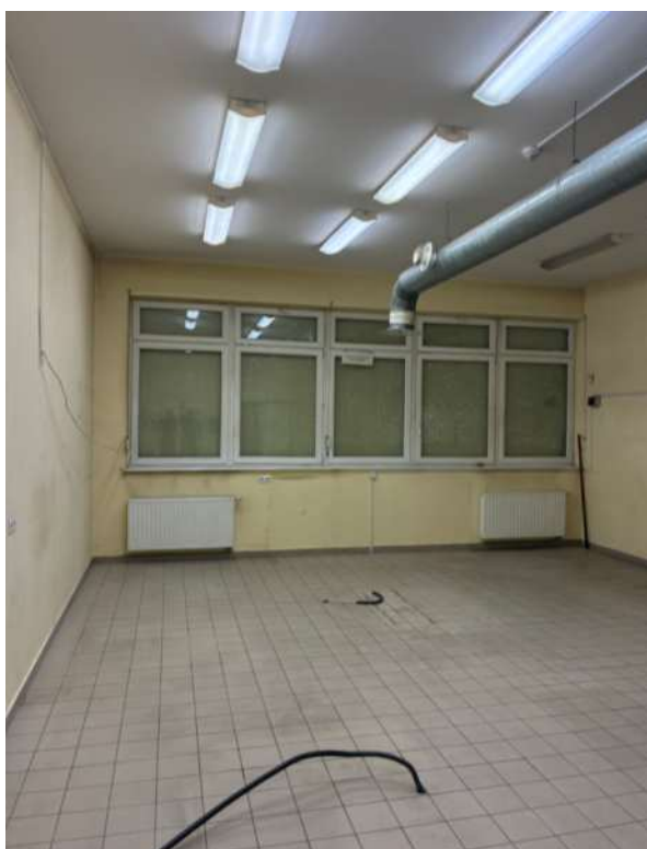
Sciana z oknami. Pod oknami grzejniki. Okna zasłonięte są obecnie roletami zewnętrznymi. W tym miejscu wydzielone zostanie pomieszczenie cleanroom ISO 7 oraz śluza. Okna z roletą przeznaczone są do pozostawienia.
